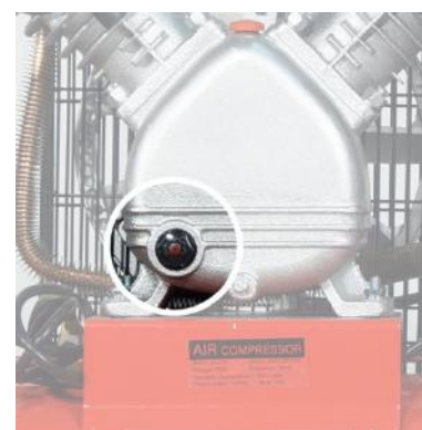
1 – маслозаливное отверстие 2 – масляный сапун
